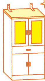
L字金具による ネジ止め
